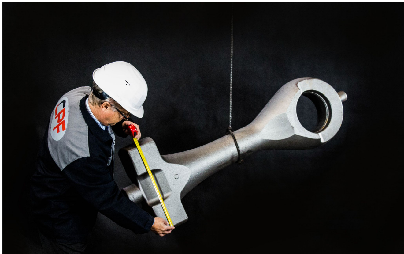
Současnost Výkovek dřívku ojnice pro motor, zákazník z Finska, hmotnost 362 kg. Present Connecting rod upper part for 4 stroke engine, Finland. Weight 362 kg.
