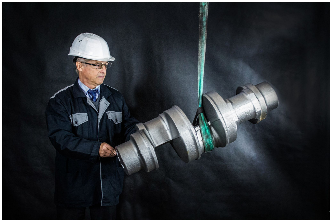
Současnost Kliková hřídel pro stroj na výrobu plechovek, zákazník z Velké Británie, hmotnost 230 kg. Present Beverage can press crankshaft, UK. Weight 230 kg.
